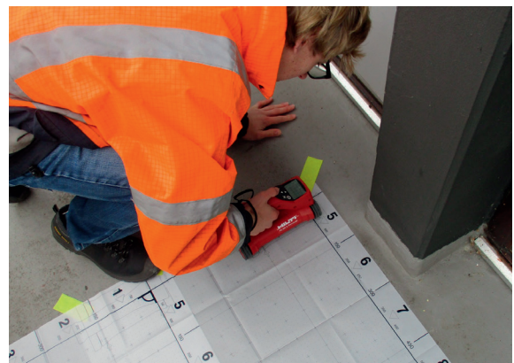
Inspectie van balkonvloer met de Ferrosican
